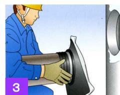
図3. ANジョイントの取り付け
