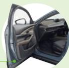
ドアの外周に組み付くシール部品。中空部とリップ部でドアとボディ間をしっかりと封止して、雨・風・音が内部に入るのを防ぎます。また防いだ雨水を下側に流す役割も合わせ持っています。
