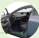
ドア開口部のボディ側に組み付く部品。ドア OUTER シールに対して2次シール的に機能します。車室内で天井材などの端部カバーの役割も担うためインテリア性も必要とされます。
